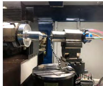
局部螺旋铣削采用 80k rpm Levicron 空气轴承主轴
