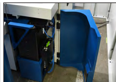
可用的 PEPS II-VX 主动机上隔振和调平
