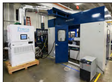
可用 Praecis 空气淋浴温度控制精度达到 ±0.01°C
